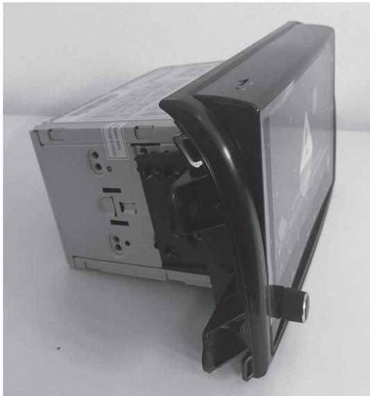
**C** Der Rahmen wird dann seitlich mit den beiliegenden M5 x 6mm Schrauben am Gerät befestigt.
