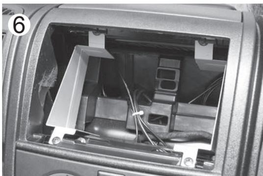
**6** Fissare la struttura per l'assemblaggio nella parte superiore e inferiore utilizzando le quattro viti con intaglio a croce (n. 4) in dotazione al sistema
