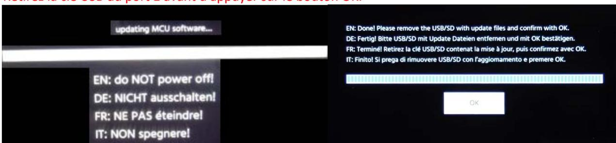
12. L'appareil va redémarrer automatiquement. Veuillez attendre jusqu'à ce que l'appareil soit complètement démarré et affiche une source de média. Vérifiez maintenant votre version détaillée en entrant dans INSTALLER > Autres > Information sur la version du logiciel. Comparez le logiciel installé avec le logiciel listé dans l'encadré de la page suivante.
