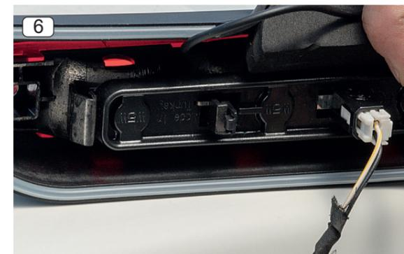
6. Den Systemstecker an den Gegenpart des Bremslicht-Reflektorgehäuses anstecken.
