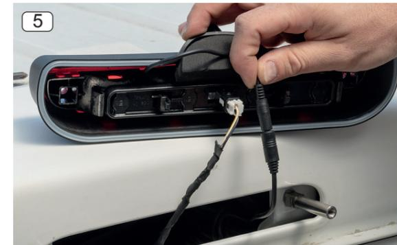
5. 2.5 mm Klinkenstecker Ausgang vom Kerasensor an das schwarze Gegenstück am Hauptkabel anstecken und mit Isolierband dicht umwickeln um das Eindringen von Wasser zu verhindern.
