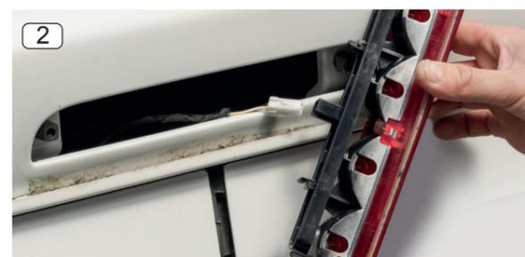
2. Bremslicht-Reflektorgehäuse abziehen.
