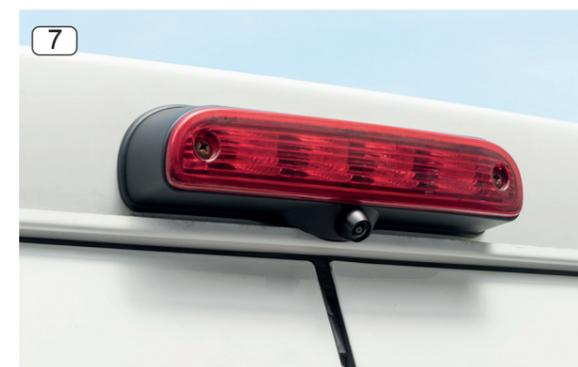
7. Den Bremslicht-Reflektor auf dem Hauptgehäuse der Kamera mit den Original-Kreuzschlitzschrauben rückmontieren.
